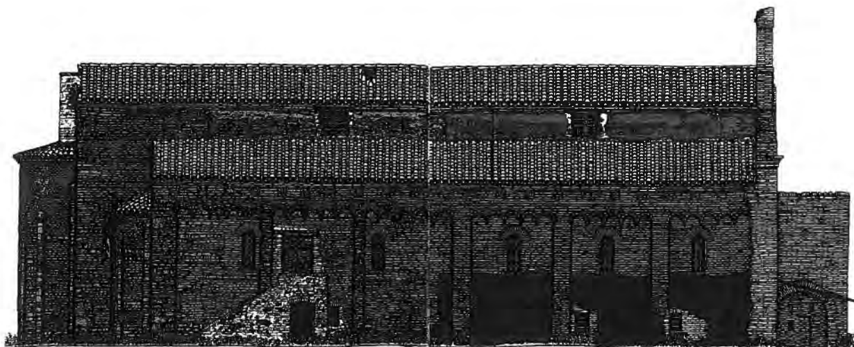
Santa Croce del Chienti, Westfassade steingerechtes Aufmaß vor der Restaurierung (Bedetta/Colacicco 1996) mit Kennzeichnung der Bauphasen gez. H. Sahler 2010
